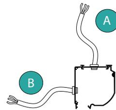
Indique la posición de salida del cable de motor según las letras de este esquema
