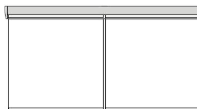
Doble caída de tela con soporte intermedio de transmisión y un solo accionamiento
